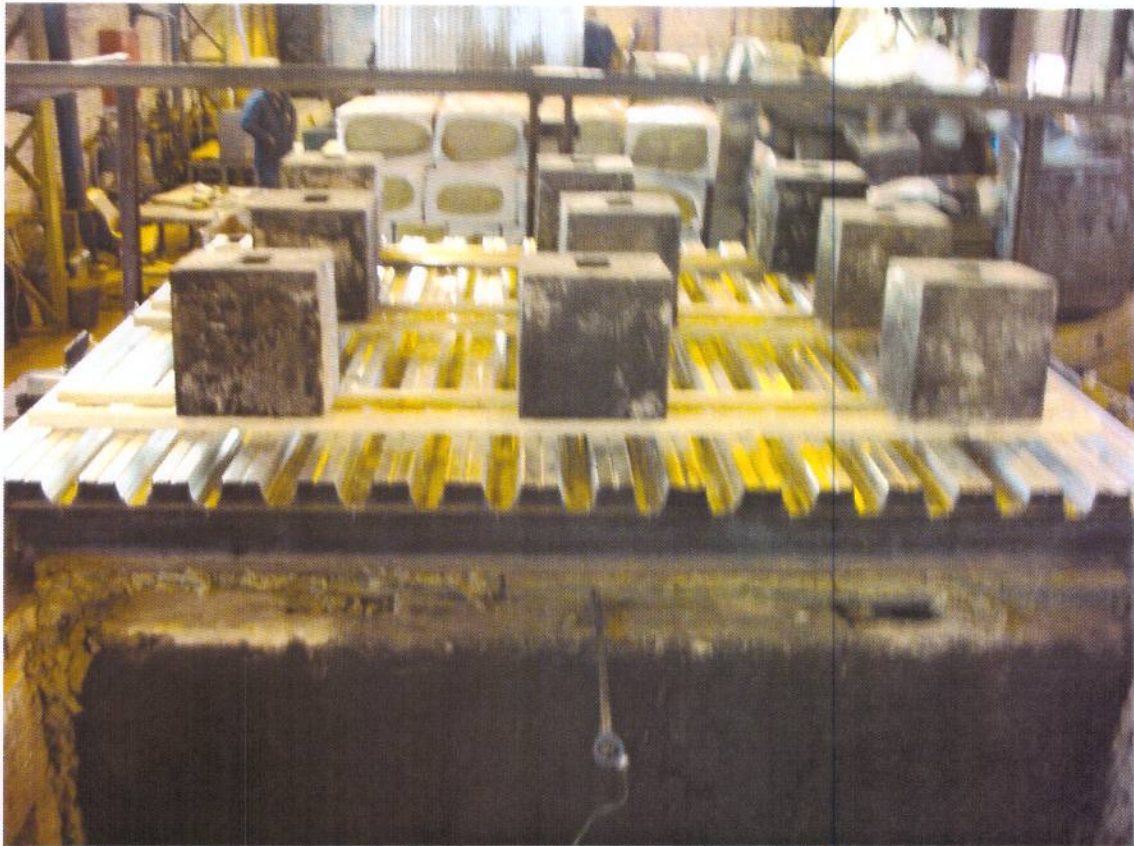
Рис. 2. Опытный образец № 1 с приложенной равномерно-распределенной нагрузкой
